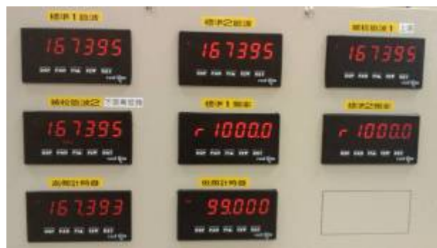
圖 2-21、高壓氣體系統新增的脈波及時間整合校正模組
