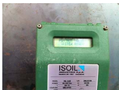
圖 4-3、在線靜電放電試驗，水量計無法計量圖
