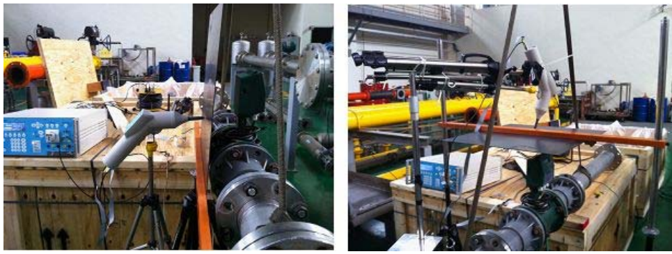
圖 4-1、離線靜電放電試驗，垂直與水平空氣放電試驗圖
