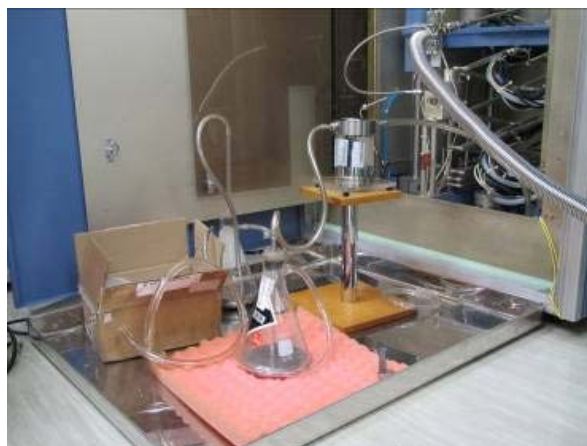
圖 2-24、灌水銀進 BAT PPS 照片圖
