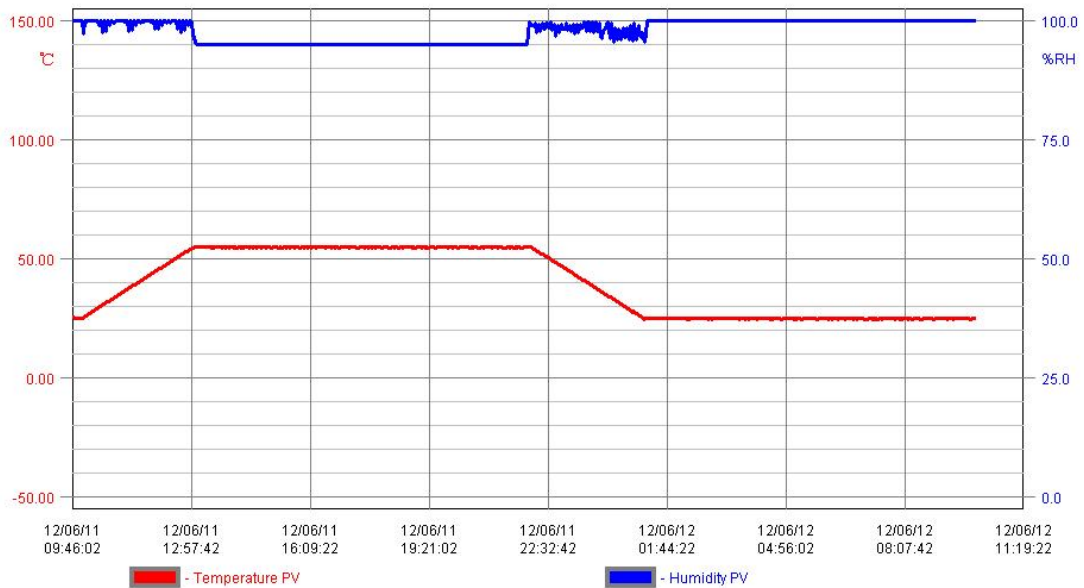
圖 4-5、試驗箱自動化後實測結果
