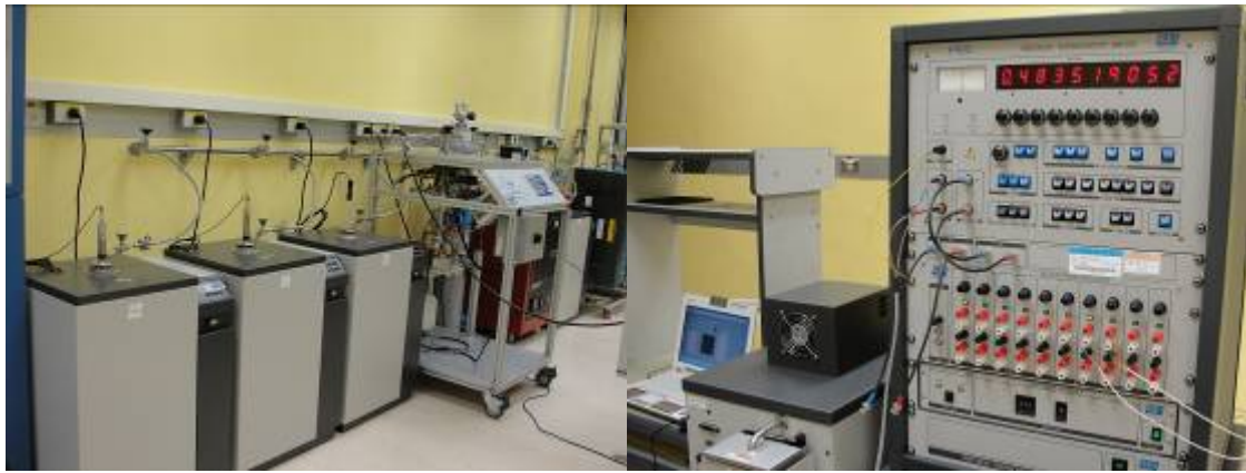
圖2-17、開放式定點囊溫度量測系統
