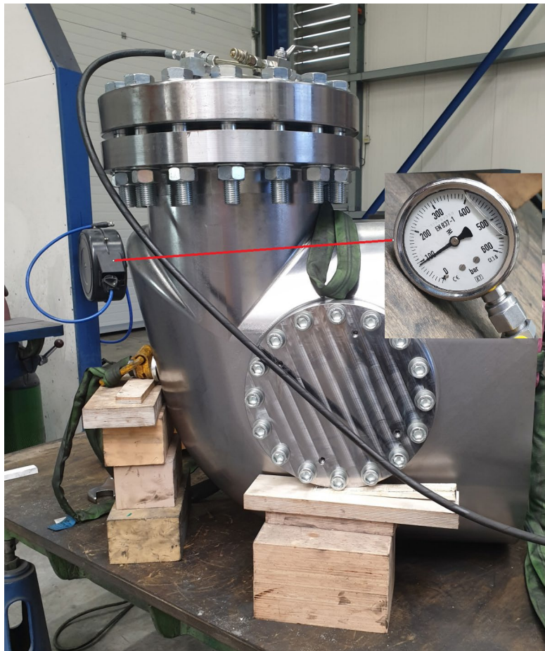
圖 1-16、鼓風機耐壓測試照片(測試壓力 96 bar)
