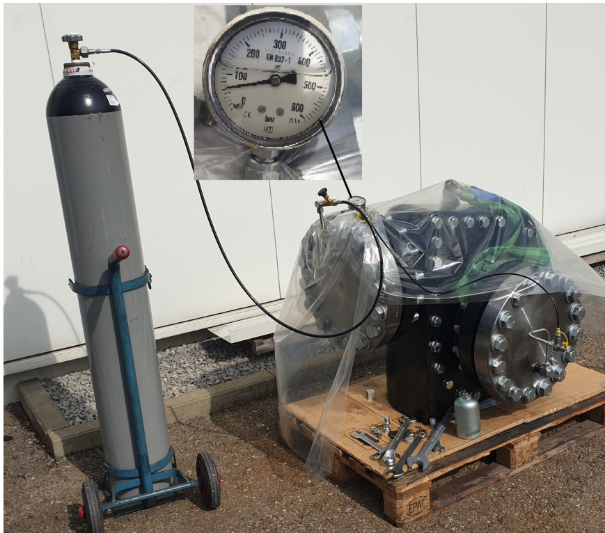
圖 1-18、洩漏測試照片(測試壓力 60 bar)
