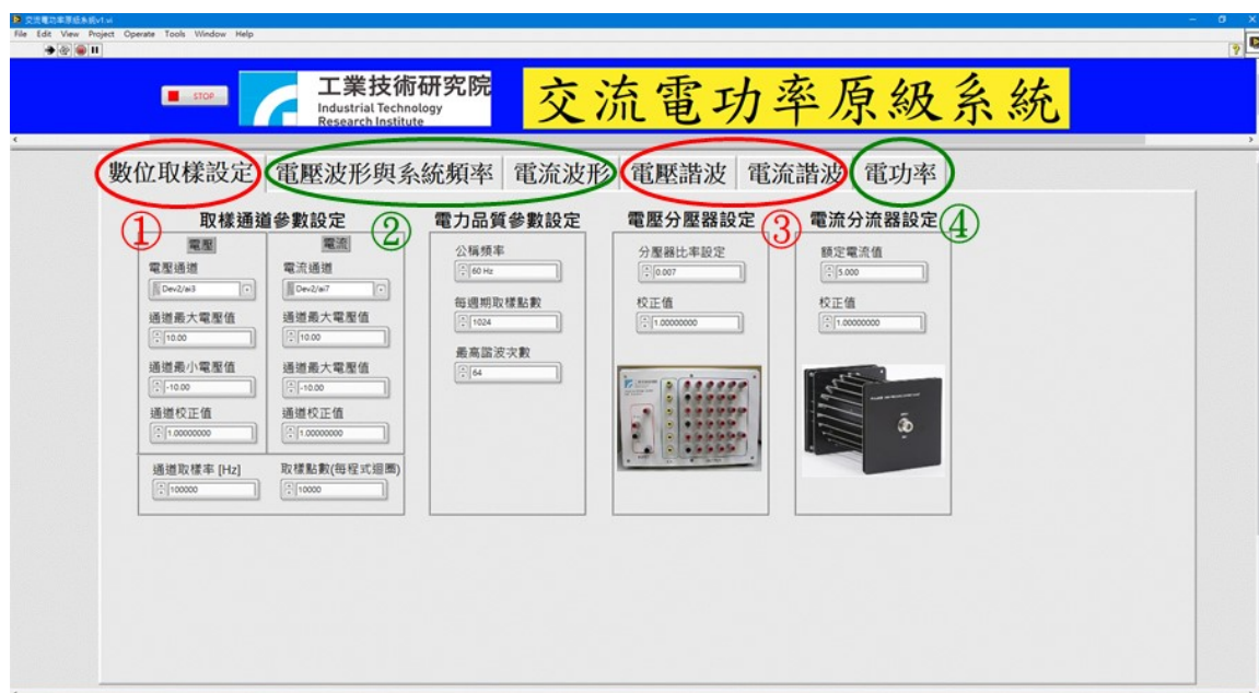
圖 2-6、電力訊號數位取樣量測平台與數位取樣設定頁
