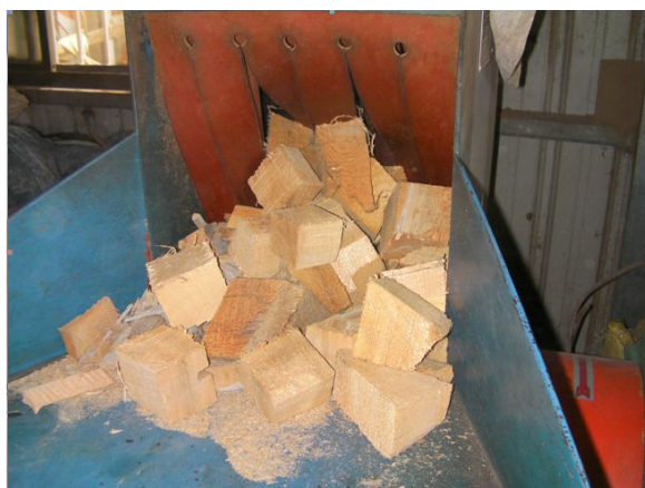
圖 1、木材裁切成小塊木塊置入粉碎機粉碎的情形
