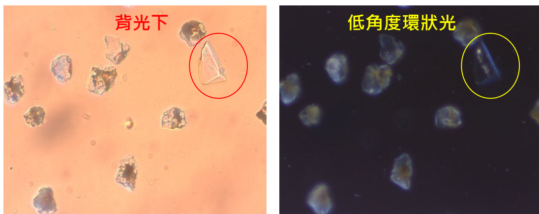
圖 13：低角度環狀光下爐渣粒子之部分反射現象
