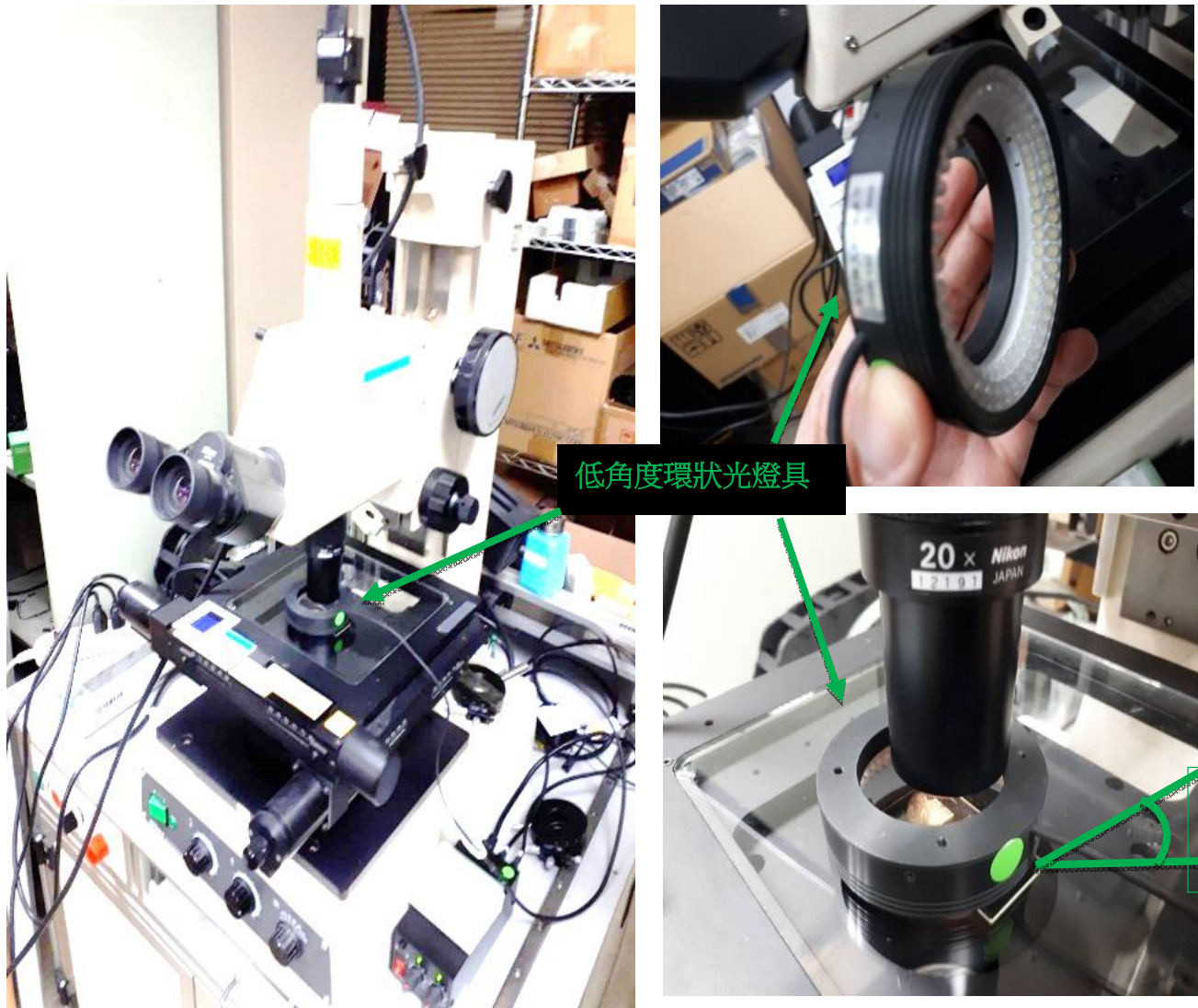
圖 5：改良版光學顯微鏡設備及低角度環狀光
