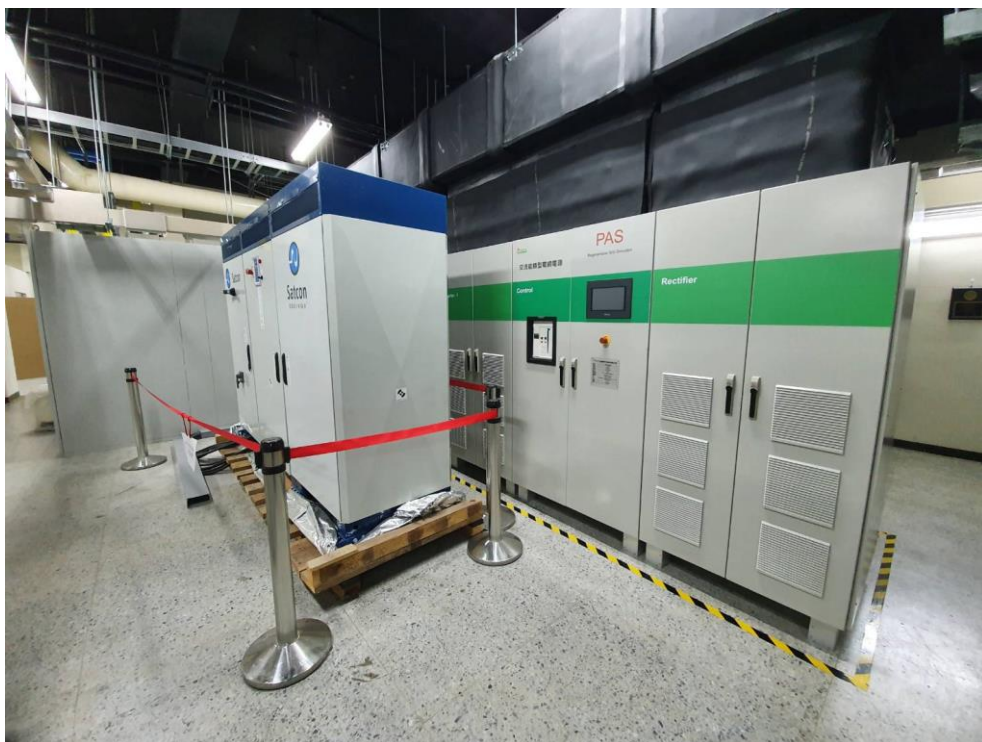
圖 25、智慧變流器測試系統交直流電源模擬器實際照片
